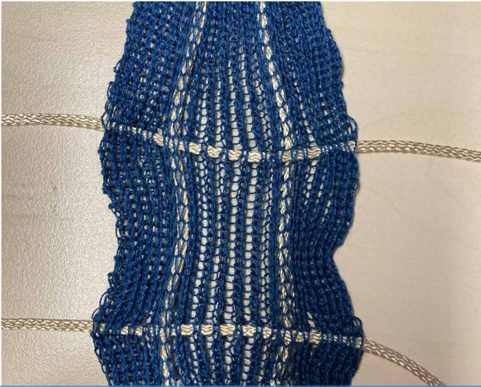
Maschenlauf Aussparungen an der Oberkante des Nadelbetts
