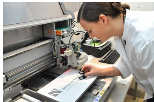
Christine Steinem (wiss. Mitarbeiterin) überprüft das Druckbild am F&E-Drucker PiXDR0 LP50 von Roth & Rau
