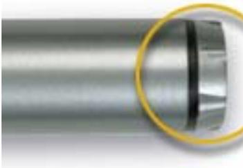
Für den Interaktiv-Stylus wird eine AA-Batterie benötigt. Zum Einlegen der Batterie müssen Sie den Deckel an der Unterseite des Stylus abschrauben und die Batterie mit dem Pluszeichen (+) nach unten hinein gleiten lassen. Setzen Sie anschließend den Deckel wieder auf, und drehen Sie ihn bis zum Anschlag ein.
