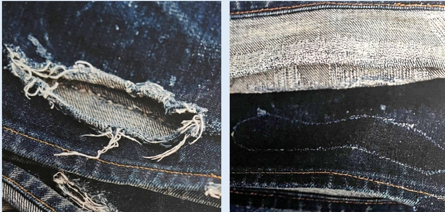
Abbildung 4-7: Reparaturergebnis einer Jeans mittels maschinelles Stopfen 93
