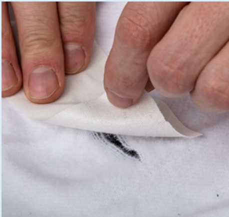
Abbildung 4-10: Anwendung des Reparaturklebebandes an einem Riss 100
