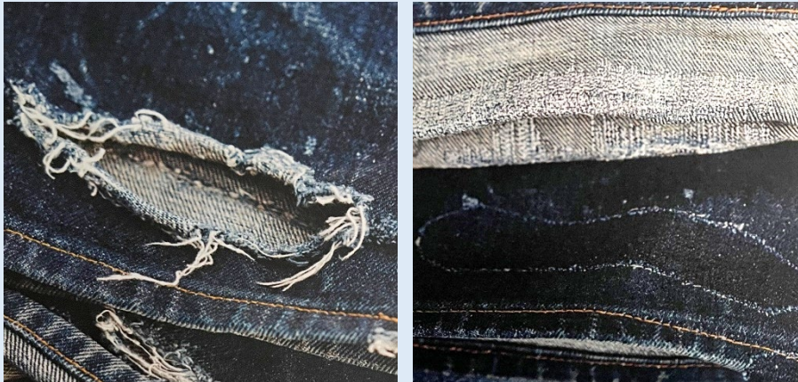
Abbildung 4-7: Reparaturergebnis einer Jeans mittels maschinelles Stopfen 93
