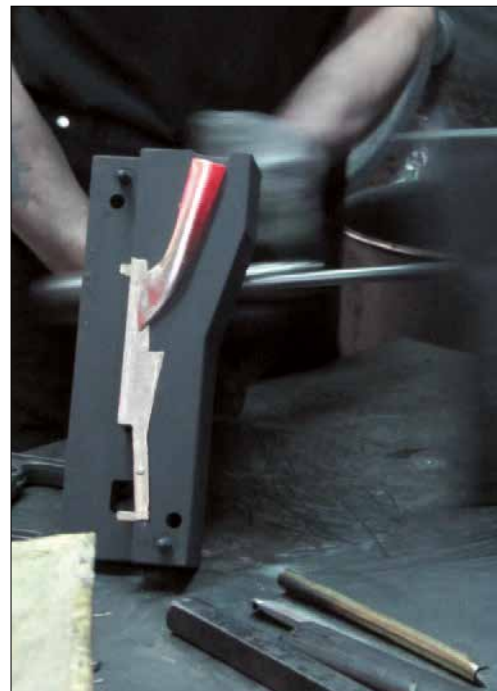
Herstellung des Iserlohner Hakens Mäander mittels Kokillenguss
