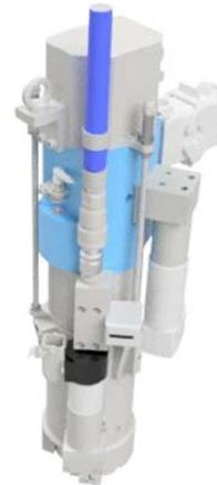
Die Firma SCHAAF hat einen Bolt Robot entwickelt, der automatisch auf einem kreisförmigen Flansch langfährt und Schrauben vorspannt. Dabei handelt es sich um Flansche die bevorzugt im Windkraftanlagenbereich und Kranbau verwendet werden. Die Schrauben werden dabei axial ohne Einleitung von nennenswerten Drehmomenten bis an die Streckgrenze des Bolzenmaterials vorgespannt. Es gibt drei Bolt Robot Größen, die folgende Gewindegrößen spannen können: M36, M42 und M48 sowie M56 und M64.
