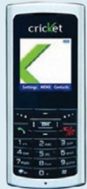
Mit RFI Shielding® behandeltes Handy Gehäuse
