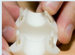
PAR3 hat die Haltbarkeit von Schnapphaken und Domen in „Z-Achsen“ Richtung nach der Beschichtung getestet. Sowohl in FDM, SL, Multijet und LS erstellte Schnapphaken wiesen im Durchschnitt um den Faktor 2 höhere Kerbschlagzähigkeit auf. Weiter wird der Biegemodul, die 3 Punkt Flexibilität, die Torsion und Haltbarkeit erhöht, so dass Sie Schnapphaken und weitere „Z-Achsen“ – Details besser biegen können, ohne dass sie brechen.
