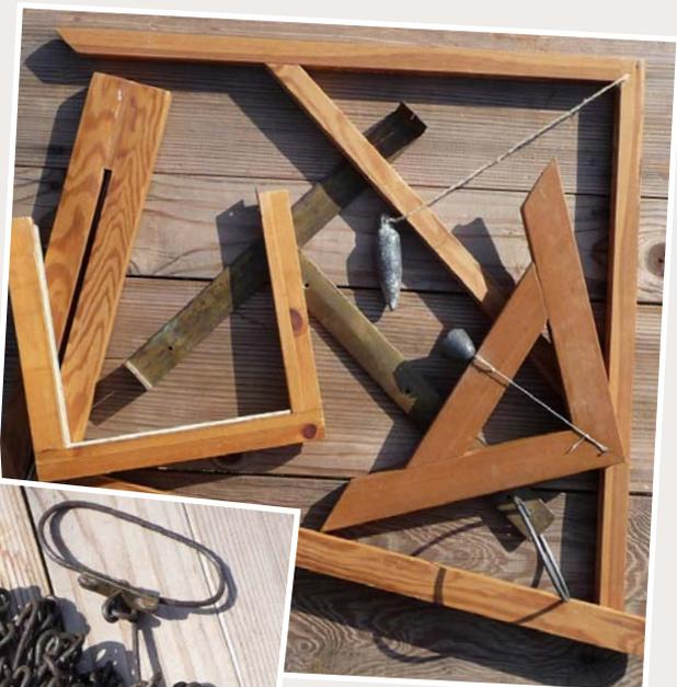
Winkelhaken, Setzwaage und Pendelwaage
