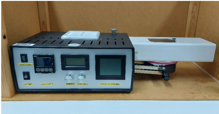
Abb. 9: Wärme- und Wasserdampfdurchlässigkeit
