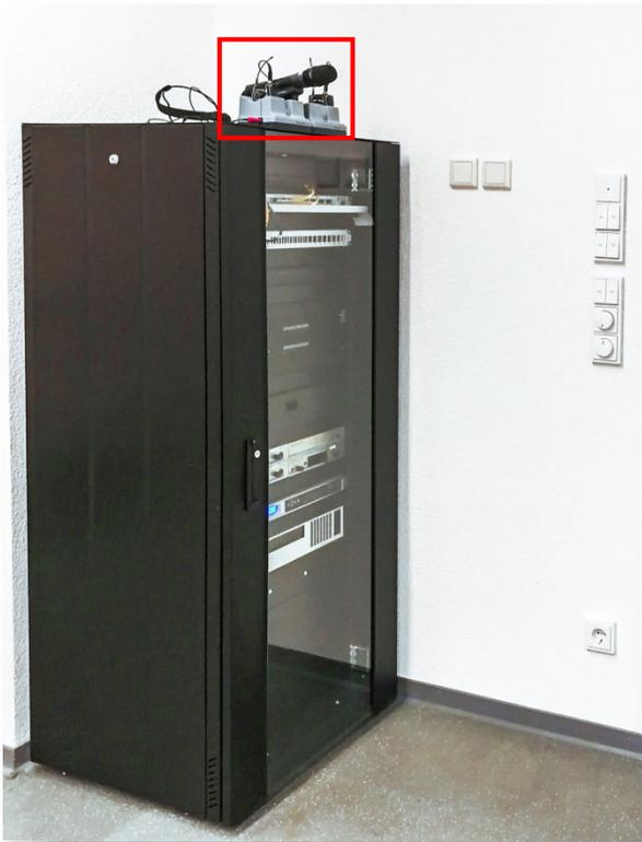
Achten Sie bitte auch darauf, dass die Mikrofone korrekt in der Ladeschale einrasten (rote LED leuchtet konstant). Ansonsten wird der Akku nicht geladen.
