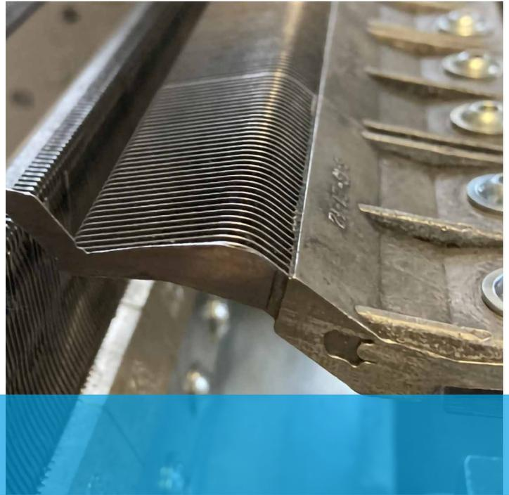
Beim Kettwirken werden Schussfäden eingelegt, die oft die Prozessgrenze in Bezug auf die Geschwindigkeit darstellen. Dieser Prozess bedarf einer Fadenführung mit hohen Massen und Beschleunigungen.
