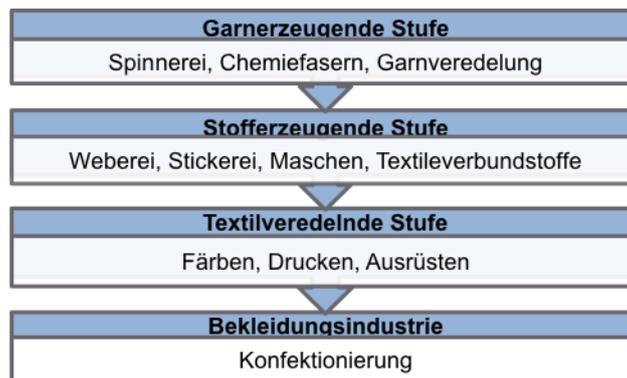
Abbildung 2-1: Textile Pipeline
