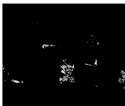
(d) Morphological (Opening, 3x3 cross) filter result
